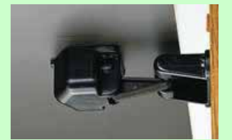
耐震ロック 普段は、普通に扉を開け閉めできますが、地震によって家具が揺さぶられたり、前方に傾くと、瞬時にロック機能が働きます。おおむね震度5以上で動作します。
